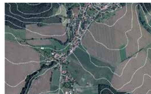
Zemědělská krajina na Moravě s vyznačením vrstevnic v polovině 20. století a dnes. Původní uspořádání výrazně menších polí orientovaných po vrstevnici zadržovalo více vody a zabraňovalo půdní erozi.
