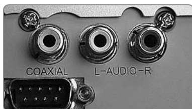
Konektory CINCH na obrázku jsou pro audio, kde na žlutém konektoru (COAXIAL je digitální stereofonní zvuk) a dále audio L a P, ale u televizoru je žlutý CINCH určen pro obraz.
