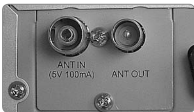
Anténní konektory slouží k připojení koaxiálního kabelu od antény (ANT IN) a dále do televizoru (ANT OUT) pro období souběžného vysílání analogového a digitálního.
